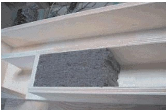
カットしたフェルト12枚を、画像のように、きっちりと、音道底部に詰め込んでください。音道の底に揃えるようにし、長さのバラツキは、開管側に出すようにします。（バラついていて構いません）
