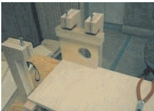
側板（パートA）を作業台に水平に（裏面が見える配置）に置いて、5センチユニットのバフル板パートKを接着します。
