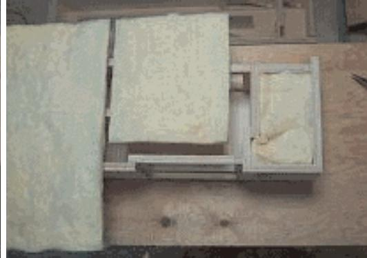
グラスウールを220mm x 220mm/ch 程の大きさにカットして、2分の1の厚みに剥いで、画像のように、上下左右周囲の壁に添うように押し付けてください。角の折り目をきちんと付けておけば、特に接着の必要はありません。
